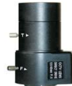
LVC-0660D Varifocal - DC Iris f=6~60mm/F1.6 Horizontal: 45°~3°
